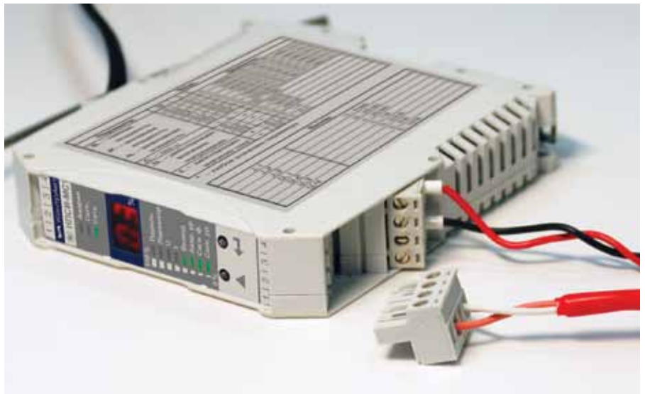
Рис. 6. Подключение внешних линий с помощью разъемных клеммных соединителей
