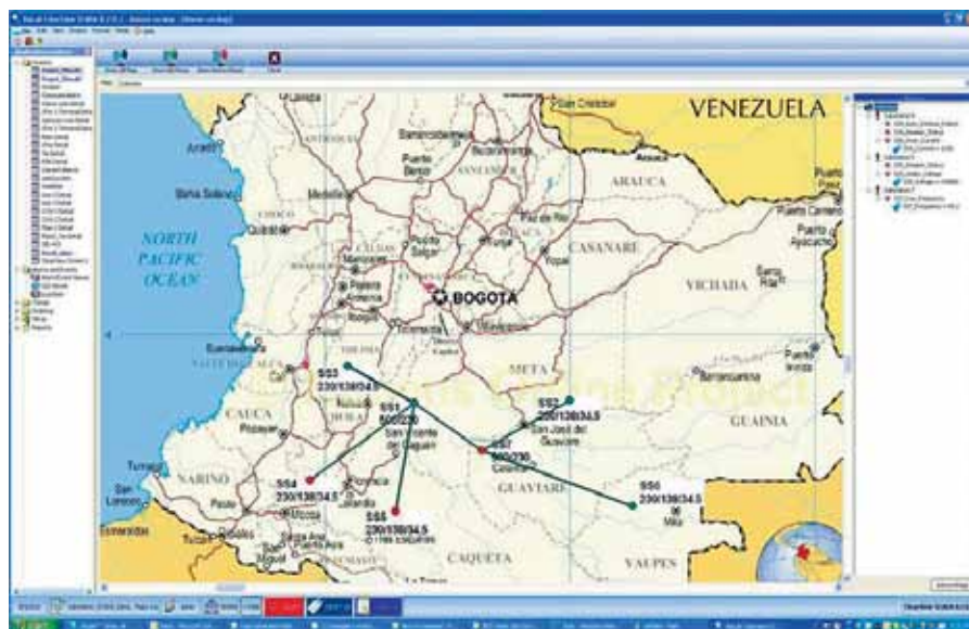
▲ Встроенная ГИС позволяет строить распределенные диспетчерские системы на базе SCADA ClearView
