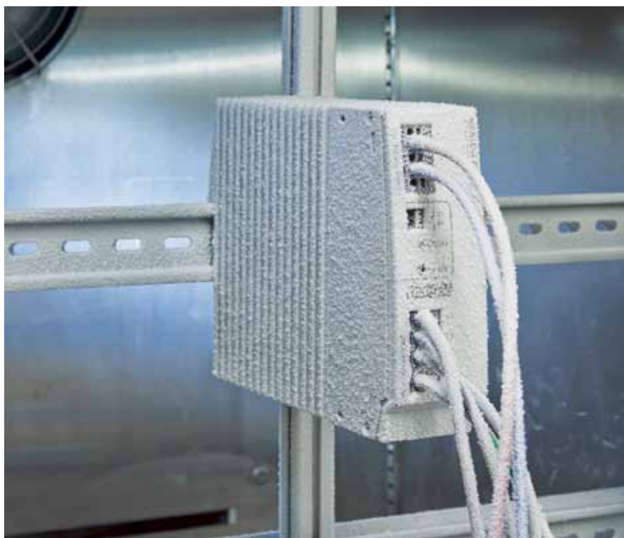
Рис. 1. Испытание TRIO POWER при низкой температуре
