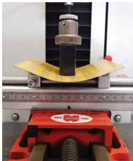
Рис. 4. Испытание пластины WE-FSFS на изгиб
