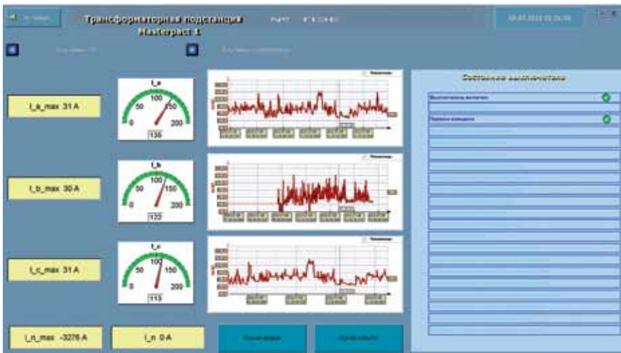
Рис. 5. Окно переключателя трансформаторной подстанции
