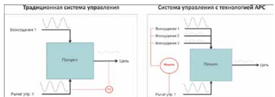
Рис.1. Воздействие на возмущение при традиционной системе управления и APC-системе
