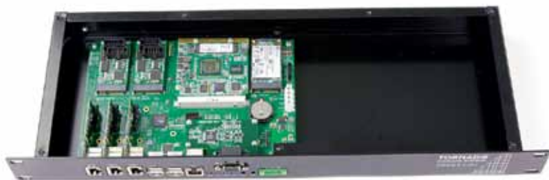
Рис. 2. Материнская плата в корпусе компьютера IPC Gridex
