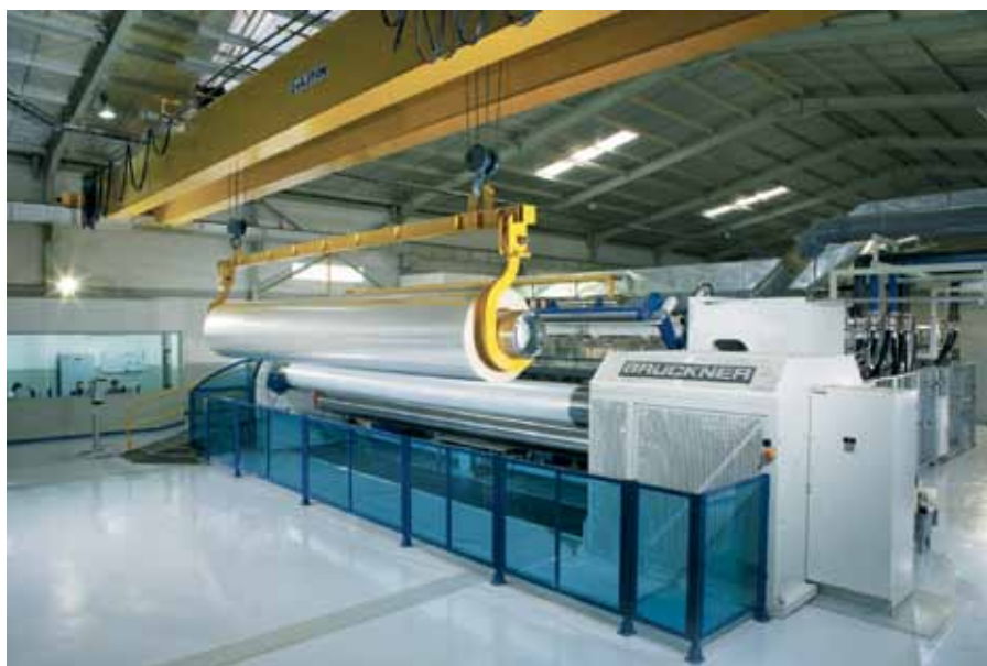
Рис. 2. POWERLINK синхронизирует все 728 осей этого станка для растяжения пленки; длительность цикла — 400 мкс
