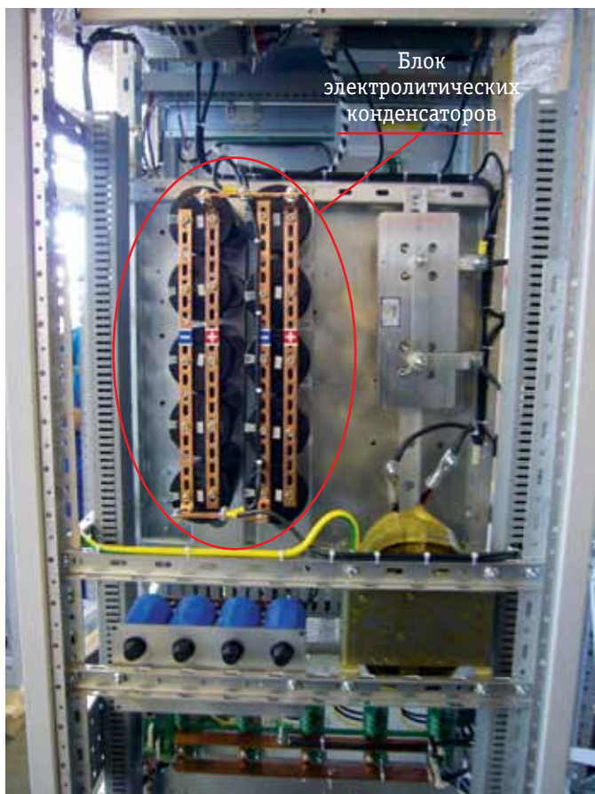
Рис. 1. Установка с электролитическими конденсаторами мощностью 10 мкФ
