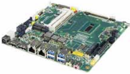
Рис. 1. Тонкая системная плата формата Mini-ITX, на которой создан одноплатный компьютер conga-IC87 с процессорами Intel Core
