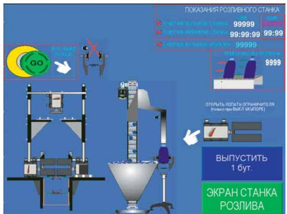
▲ Экран станка розлива: подпрограмма для удаления из аппарата одной бутылки
