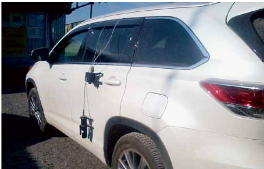
Рис. 1. Оптический датчик ИСД-3 и лазерный ИСД-5, закрепленные на автомобиле во время тестовых заездов
