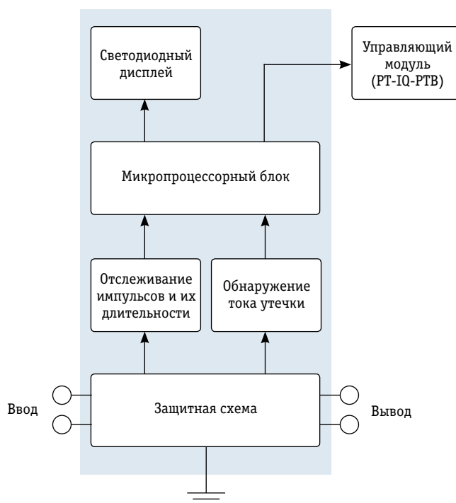
Рис. 2. Система контроля на базе микропроцессора точно определяет статус защитного устройства, используя сложный алгоритм
