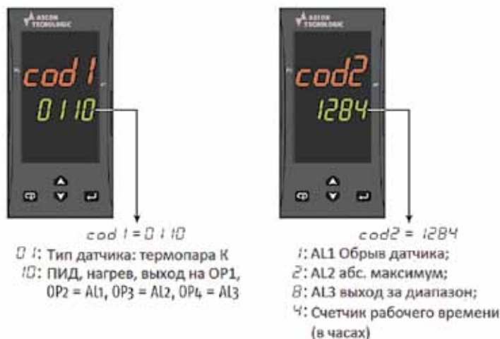
Рис. 4. Настройка прибора при помощи цифрового кода
