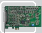
PCIE-1810 12-бит, 16-ch AI, До 800K отсчетов/с
