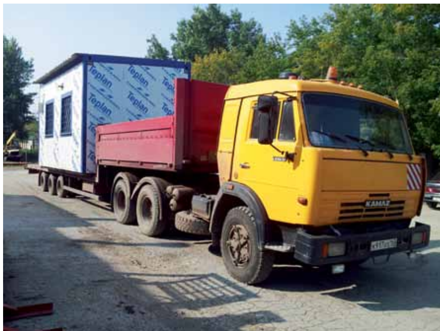
Рис. 4. Транспортировка модуля котельной к месту назначения
