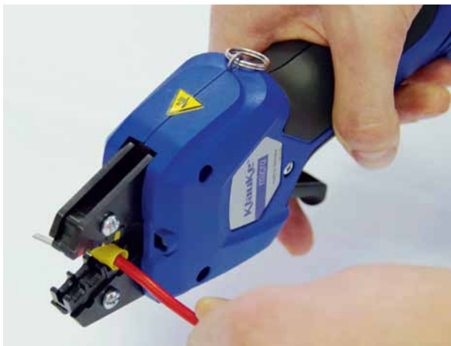
Рис. 2. Опрессовка с помощью инструмента KLAUKE-Micro
