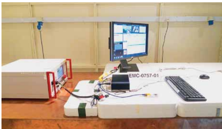
Рис. 4. Промышленный ПК Kontron KBox A-101 в лабораторном тестировании на устойчивость к воздействию электромагнитных помех в соответствии со стандартом EN 61000-4-4
