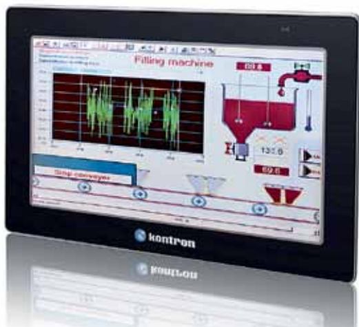
Рис. 5. Панельные ПК Micro Client 3 представляют собой одноплатные компьютеры на базе Intel Atom D2550, характеризующиеся широкими возможностями по работе с накопителями и разнообразием высокоскоростных внешних интерфейсов
