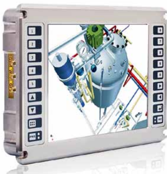
Рис. 7. Обладая защитой уровня IP65 по всей поверхности корпуса, панельный ПК «РТКон» подходит для широкого круга промышленных приложений
