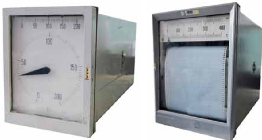
Рис. 3. Слева – КП-1 производства завода «Автоматика» (г. Кировокан, Армения); справа – старый КСП-2
