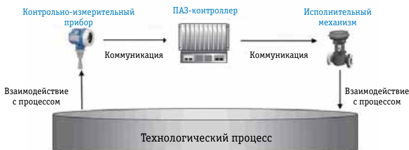
Рис. 1. Приборная система безопасности согласно ГОСТ Р МЭК 61511
