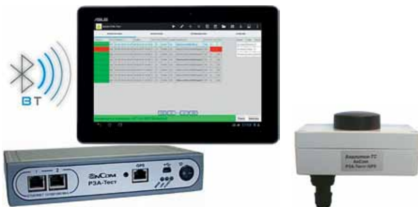
Рис. 2. Приборный блок с управляющим планшетом и устройством синхронизации времени
