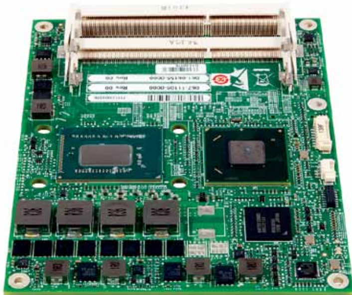
Рис. 1. Процессорный модуль CEQM77 с процессором Intel Ivy Bridge
