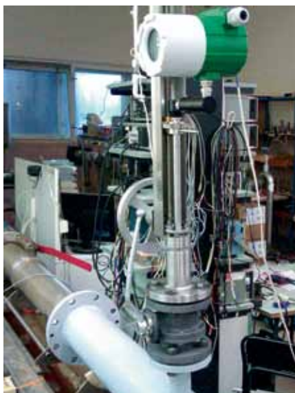
Рис. 3. Поверка погружного расходомера серии M23
