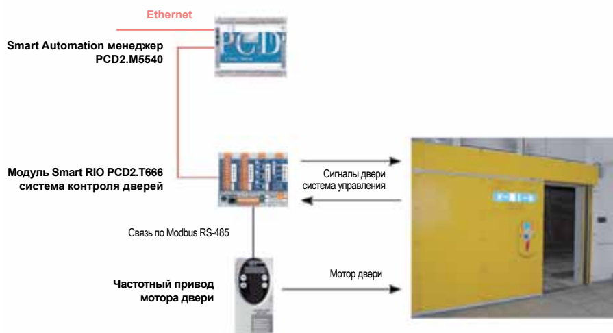
Рис. 4. В Лечбергском туннеле мониторинг дверей перекрестных туннелей осуществляется с помощью PCD3.T666. Прикладная программа создана в среде разработки PG5
