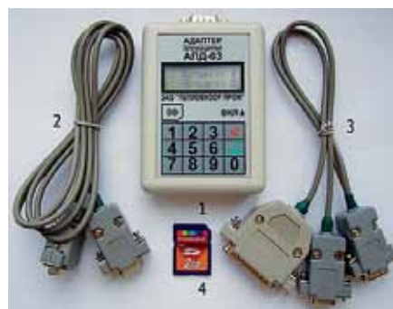
Рис. 2. Комплект адаптера переноса данных: 1 – АПД-03; 2,3 – коммуникационные кабели; 4 – SD-карта
