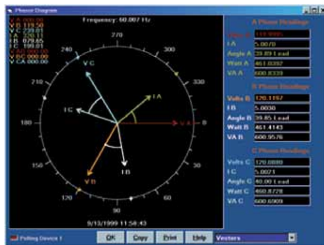
▲ Векторная диаграмма углов сдвига фаз тока и напряжения
