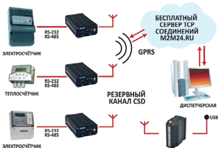
Рис. 1. Схема работы GPRS-терминалов TELEOFIS серии WRX700
