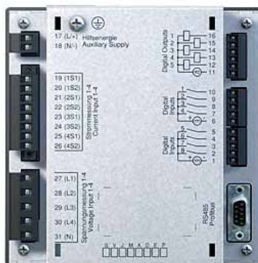
Рис. 2. Схема подключения прибора
