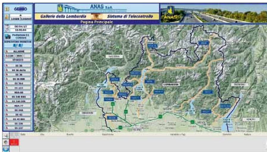
Рис. 2. Система дистанционного мониторинга и контроля туннелей Ломбардии на основе PCVue
