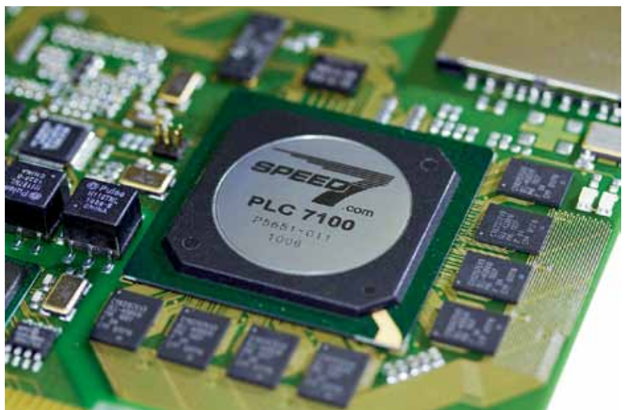
▲ Высочайшая производительность контроллеров VIPA обеспечивается специализированным процессором, разработанным в рамках технологии SPEED7
