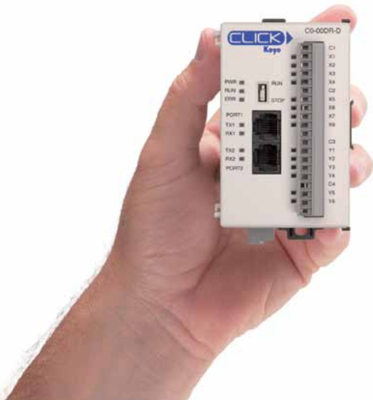
Рис. 1. ПЛК CLICK – мощное самостоятельное устройство с возможностью расширения до 142 точек ввода/вывода
