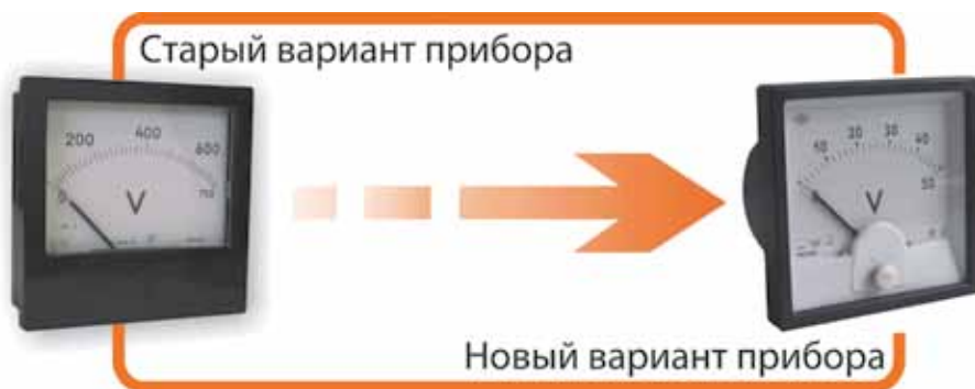
▲ Разница между старым и новым вариантом стрелочного амперметра
