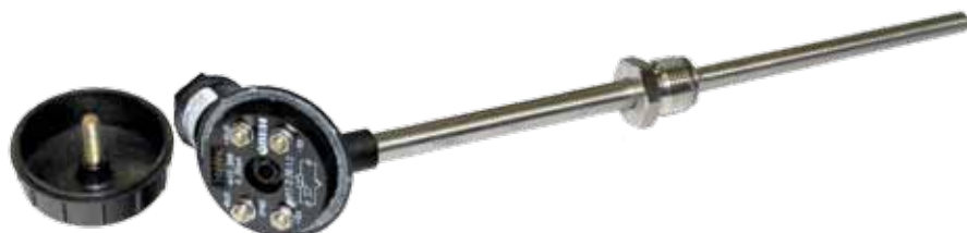
Рис. 7. Нормирующий преобразователь НПТ-2, установленный в датчик
