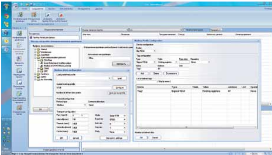
Рис. 11. Конфигурирование коммутатора «логгер-студия» системы разработки Dream Report Studio. Конфигурирование коммуникационного драйвера MBus протокола Modbus. Конфигурирование профиля (группы тегов) V120 драйвера
