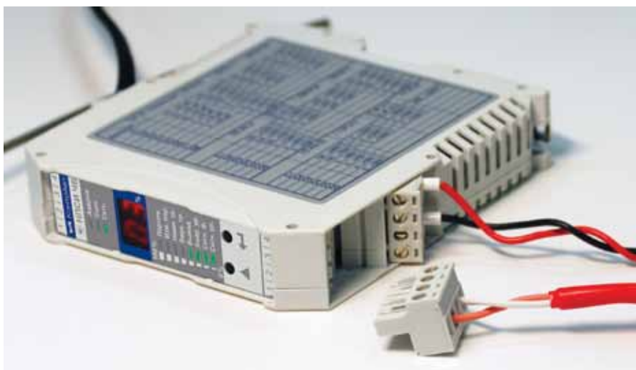
Рис. 10. Подключение внешних линий с помощью разъемных клеммных соединителей
