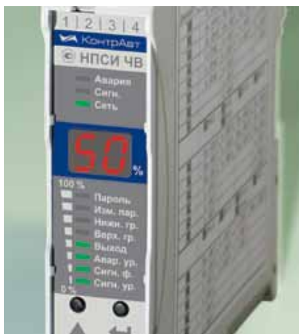
Рис. 9. Органы индикации и управления на передней панели преобразователя
