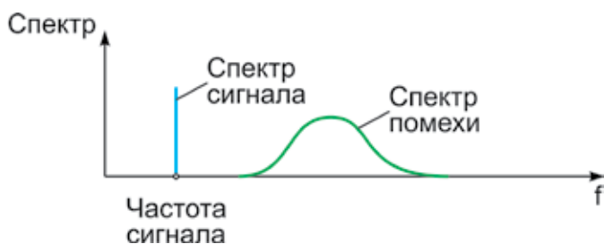
Рис. 3. Измерение периода сигнала спектральным методом при наличии помехи
