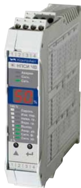
Рис. 6. Внешний вид нормирующего преобразователя частотно-временных параметров периодических сигналов НПСи-ЧВ, выпускаемого НПФ «КонтрАвт»
