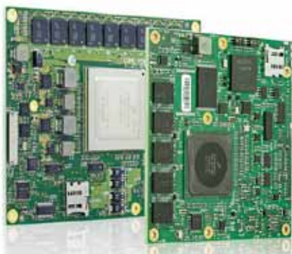
Рис. 2. Модули COM Express компании Kontron на базе процессоров Freescale QorIQ с архитектурой Power
