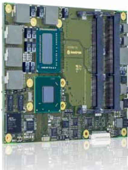
Рис. 1. Модуль стандарта COM Express от компании Kontron на основе процессоров третьего поколения Intel Core
