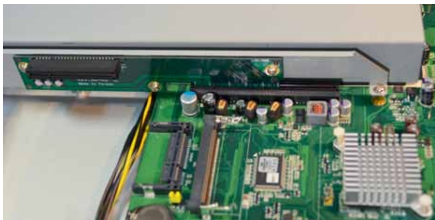
Рис. 5. Слот PCI Express X8 с райзер-картой
