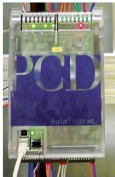
▲ Контроллер Saia® PCD1.M2 с модулем M-Bus
