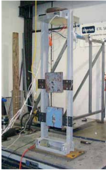
▲ При тестировании на соответствие стандарту NEBS по сейсмоустойчивости создаются условия, аналогичные подземным толчкам магнитудой выше 8 баллов по шкале Рихтера
