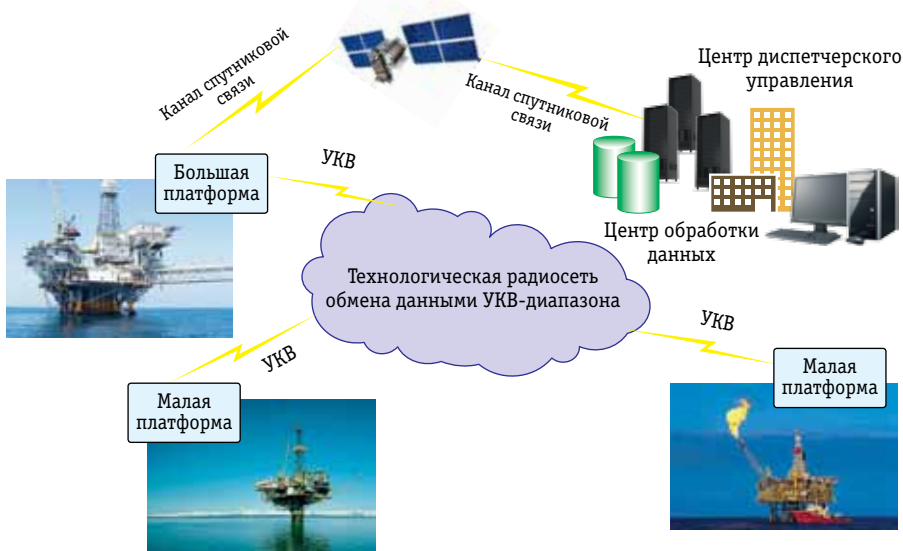
Рис. 3. Упрощенная схема гетерогенной технологической радиосети обмена данными в системе управления группой морских буровых платформ
