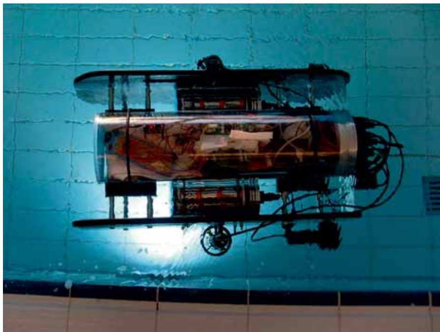
▲ Автономный подводный автомат с fit-PC2
