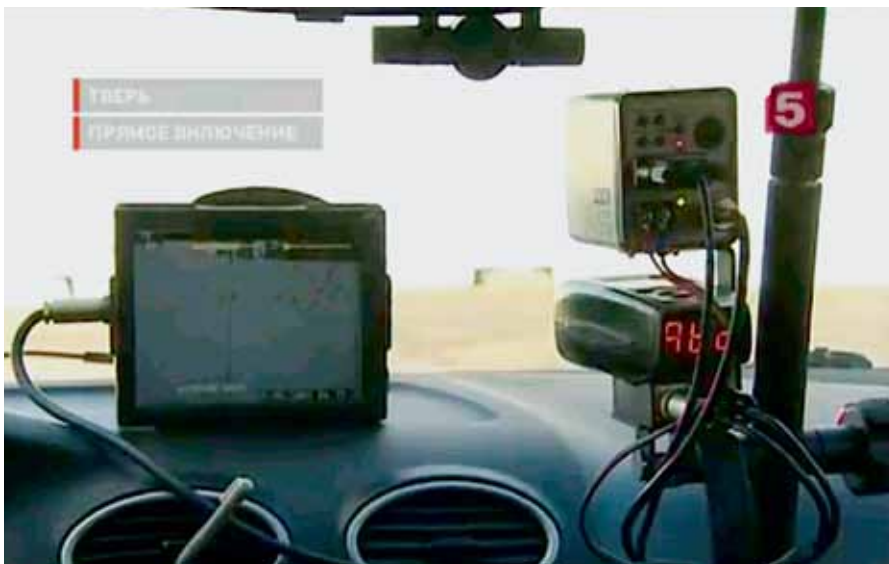
▲ Бортовой компьютер «АРГУС-БК», работающий на основе fit-PC2, в новом патрульном автомобиле ДПС
