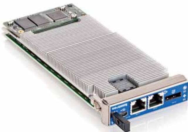
▲ Процессорный модуль Kontron AM4022 выполнен на чипсете Mobile Intel QM77 и в стандартной конфигурации комплектуется процессором Intel Core i7-3555LE или Intel Core i7-3612QE
