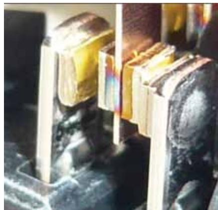
▲ Контакты реле серии MY-S покрыты золотом для обеспечения наивысшей надежности соединения
