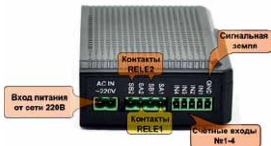
Рис. 2. Внешние разъемы устройства. Сторона 1
