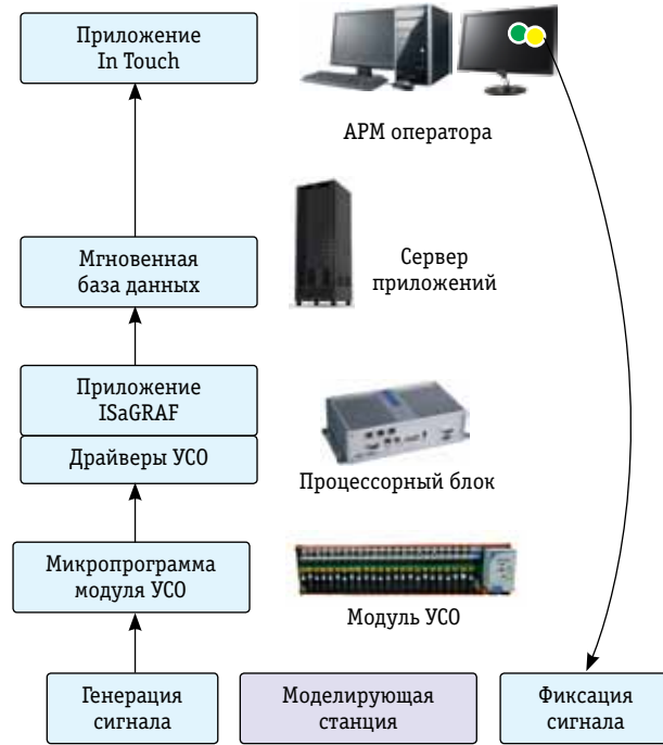
Рис. 4. Схема измерения общей задержки между установкой сигналов и их отображением на АРМ оператора
