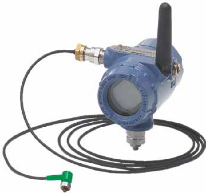
Рис. 1. Датчик вибрации CSI 9420 отправляет данные об оборудовании в интегрированную сеть управления предприятием через беспроводной шлюз. По данным одной нефтеперерабатывающей компании, установка этих полевых устройств занимает пару часов, по сравнению с несколькими днями при установке проводного устройства
