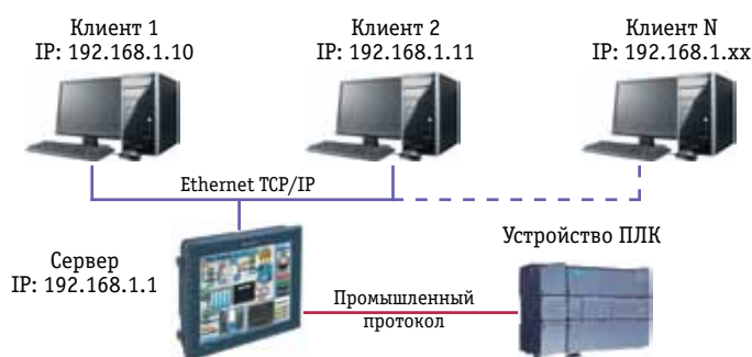
Рис. 1. Клиент-серверная технология для объединения устройств управления в единую сеть по топологии «один сервер – N клиентов»
