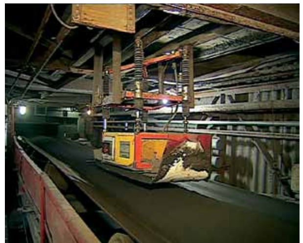
Рис. 2. Анализатор на конвейере агломерационного цеха
