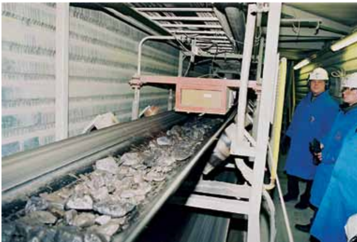
Рис. 1. Рентгенофлуоресцентный анализатор Con-X 02 на обогатительной фабрике
