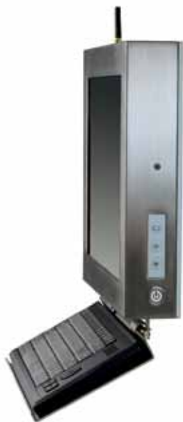
▲ Панельный компьютер с защитой IP66 по «кругу» GOT-815
