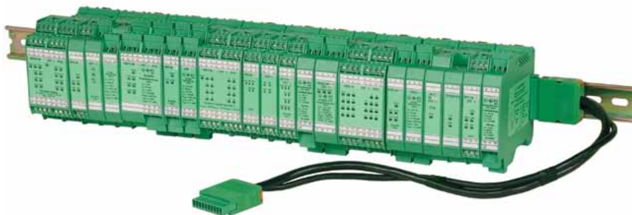
Рис. 1. Промышленный комбинированный контроллер ГАММА-11
